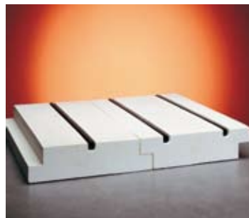
Рис. 7 FibroSiC – не требующие опор изоляционные блоки для свода, укрепленные карбидкремниевыми трубками
