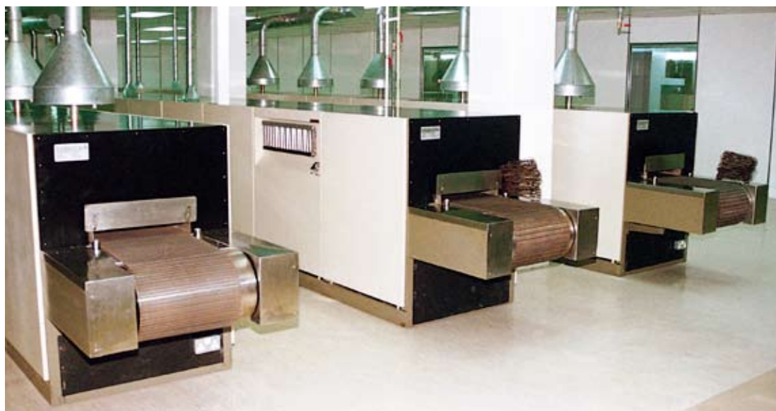
Рис. 32 Модули FIBROTHAL в конвейерной печи
