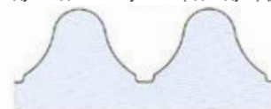
Single-arc gear hob (for convex teeth) / Червячная фреза с дугообразными зубьями (одна дуга) (для выпуклых зубьев) / Черв'ячна фреза з дугоподібними зуб'ями (одна дуга) (для випуклих зубів)
