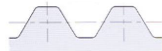
Tooth profile of gear hob / Профиль зуба червячной фрезы / Профиль зуба черв'ячної фрезы
