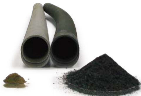
Рис. 4 Сравнение APMT трубы с Fe-35Ni-25Cr (после 2300 ч при 1100°C). Жаропрочные трубы целиком покрыты окалиной.
