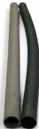
Рис. 2 KANTHAL APMT (слева) и Fe-35Ni-25Cr (справа) после теста на прогиб
