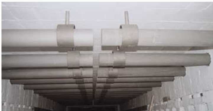
Установка РМ труб и нагревателей TUBOTHAL в линию непрерывного отжига
