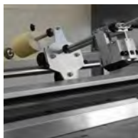
Две станции: ленточное шлифование и финишная обработка на одной установке
