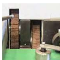
Опция: вращающиеся щетки для получения формы ламелей (закругления кромки ламельного типа) после шлифовки боковых плоскостей
