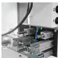
Пневматическое натяжение ленты
