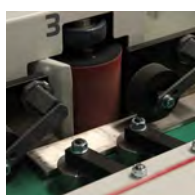
Опция: вращающиеся щетки для получения формы ламелей (закругления кромки ламельного типа) после шлифовки боковых плоскостей
