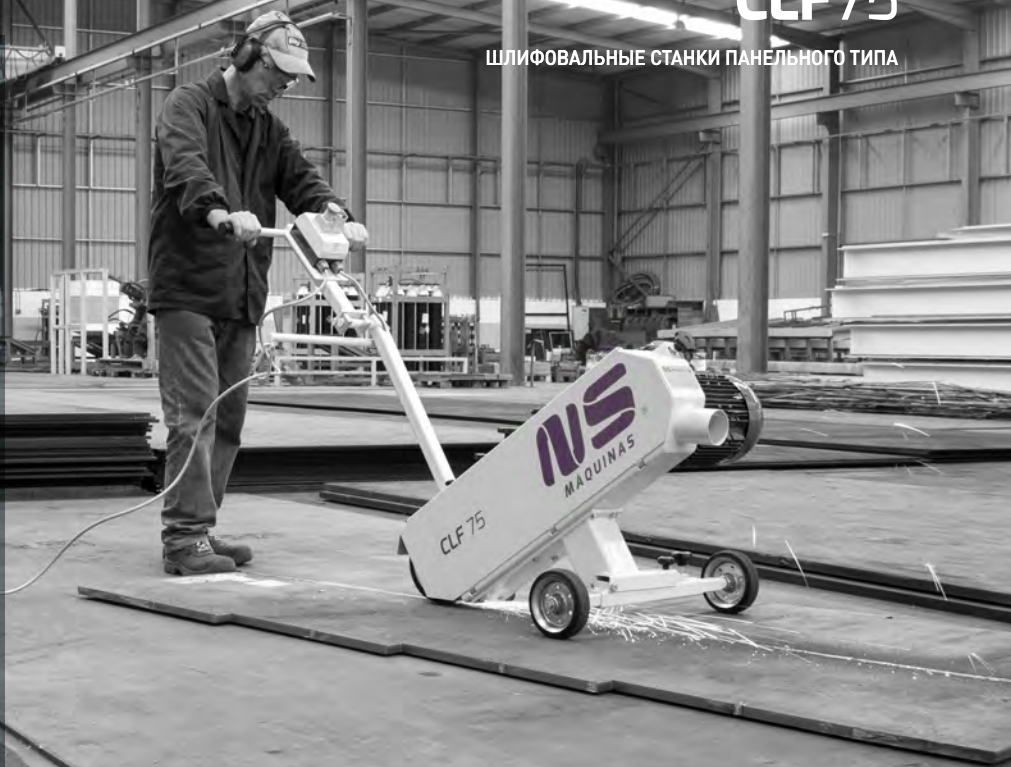
Удаление заусенцев и чистка сварных швов на толстых листах металла
