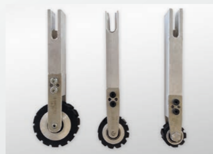
Quick change contact wheel holder Ø 15–80 mm, also as tactil measuring version. Schnellwechsel Kontaktscheibenhalter Ø 15–80 mm, auch als Messtaster Variante.
