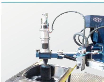
Sidewall polishing. Seitenwandbearbeitung.
