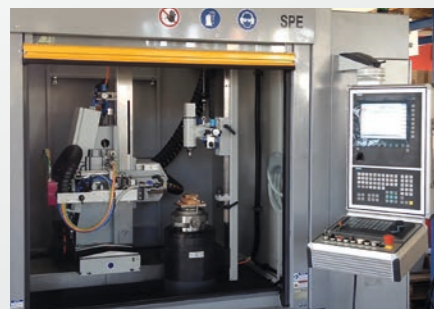
SPE machine with extended swing type operator panel (option). SPE Maschine mit schwenkbarem Bedienpult (optional).
