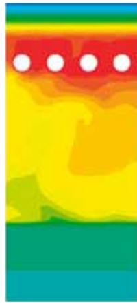
Распределение температур (in °C) внутри миксера. Коэффициент черноты свода = 0.25, коэффициент черноты зеркала алюминия = 0.1.
