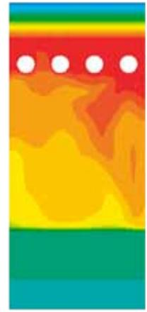
Распределение температур (in °C) внутри миксера. Коэффициент черноты свода = 0.55, коэффициент черноты зеркала алюминия = 0.1.
