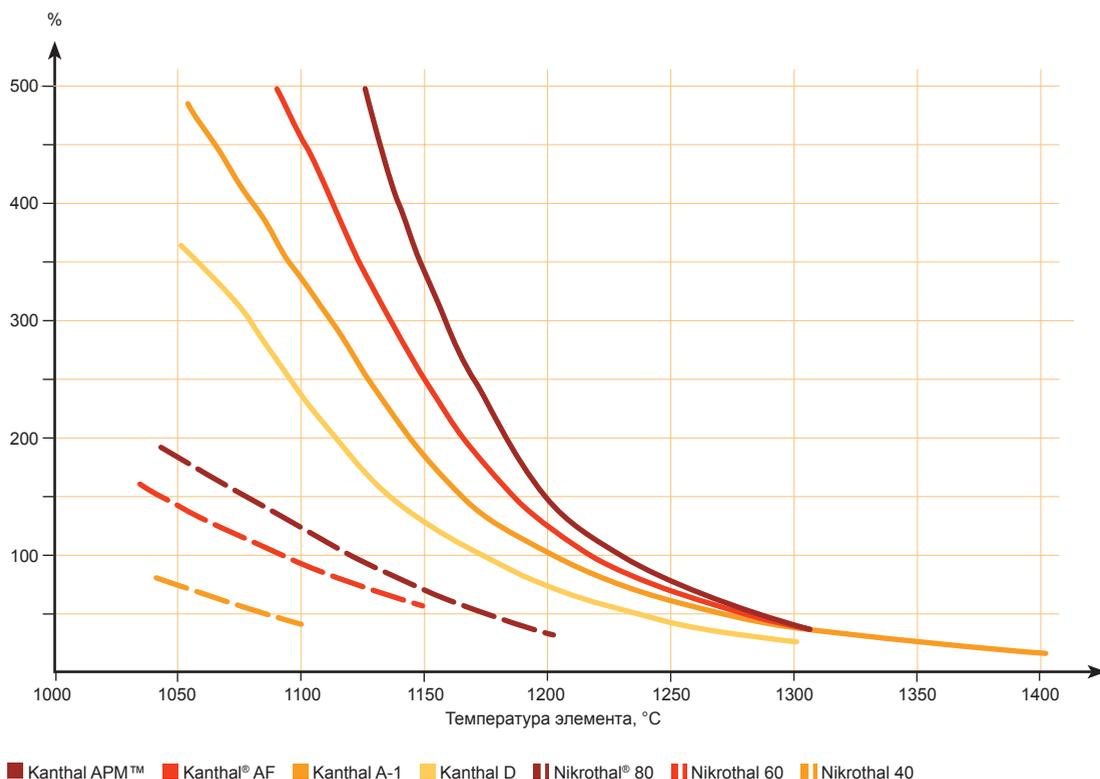
на единицу поверхности может использоваться для формирования новой окисной пленки. Поэтому при одной и той же температуре элементы из проволоки большего сечения будут обладать более длительным сроком эксплуатации, чем элементы из проволоки тонкого сечения. Соответственно для элементов из ленты увеличение толщины приводит к продлению срока службы. Как правило, мы рекомендуем минимальный диаметр для проволоки 3 мм и минимальную толщину для ленты 2 мм.
