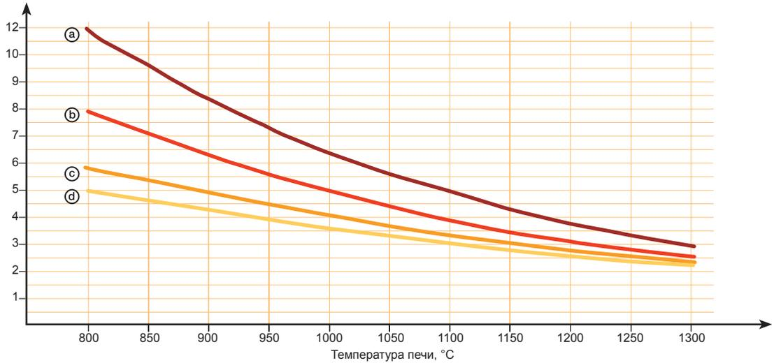
**Максимально рекомендуемая удельная нагрузка на поверхность элемента для сплавов Nikrothal в промышленных печах**
